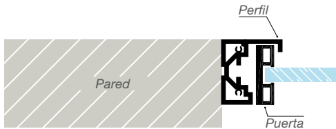
Sin cabecero o perfil superior (instalación a techo)
