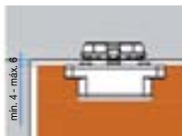
Instalación a falso techo
