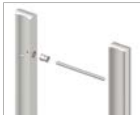
Fijación tornillo pasante para puertas de madera
